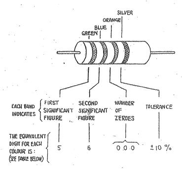
THEREFORE, THE RESISTOR SHOWN ABOVE HAS AN OHMIC RESISTANCE OF : 56 000  $\Omega$   $^2$  10  $^9\!/_{\!\circ}$  .
